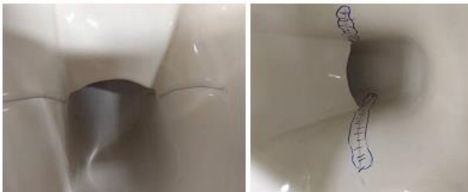
Figura 1: Imagem da trinca de requeima de vaso sanitário.
