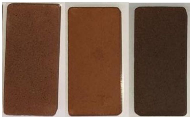
Figura 5: Corpos de prova com 60% de pó de vidro moído no moinho de bolas durante 15 minutos. a) queimada a 900°C b) queimada a 950°C c) queimada a 1000°C.
