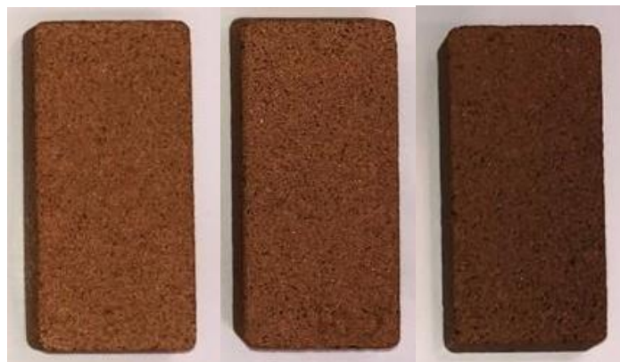
Figura 5: Corpos de prova com 60% de pó de vidro moído no moinho de bolas durante 15 minutos. a) queimada a 900°C b) queimada a 950°C c) queimada a 1000°C.
