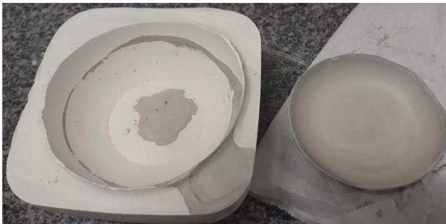
Figura 3- Molde que recebeu silicone spray como desmoldante e peça após o desmolde.
