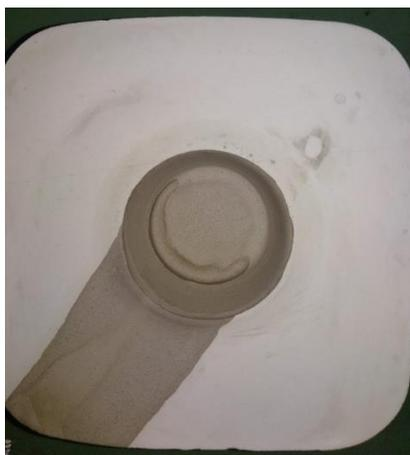
Figura 1- Molde de gesso com colagem após 48 horas.
