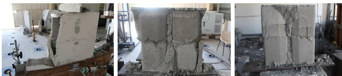
Figura 8- Módulo de ruptura prismas sem graute, graute convencional e leve, respectivamente
