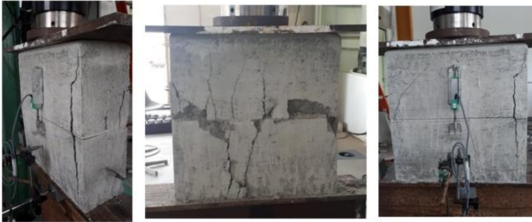
Figura 8 – Modo de ruptura dos prismas com argamassamento total.
