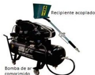
Figura 2: Recipiente acoplado.
