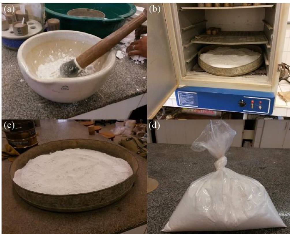
Figura 1 – Processo de reciclagem dos resíduos de gesso: (a) Moagem do resíduo de gesso; (b) Calcinação; (c) Gesso calcinado; (d) Gesso acondicionado.
