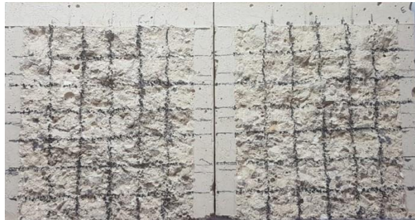
Figura 3 – Região fraturada de um corpo de prova para contagem dos agregados arrancados e fraturados com a grade de contagem.
