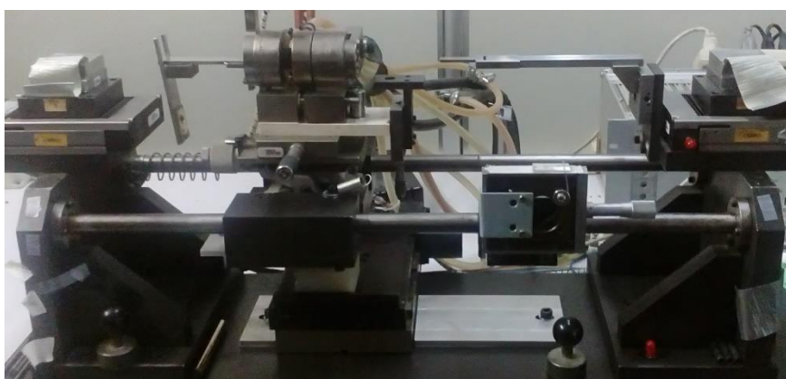
Figura 2. Máquina de fabricação de acopladores pelo processo de aquecimento e puxamento da empresa OptoLink Ltda.
