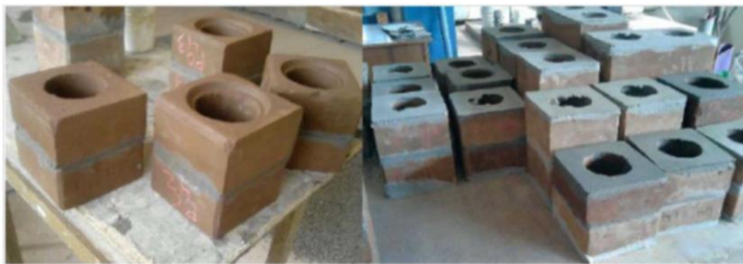
Figura I- Tijolos cortados ao meio com pasta de cimento portland.
