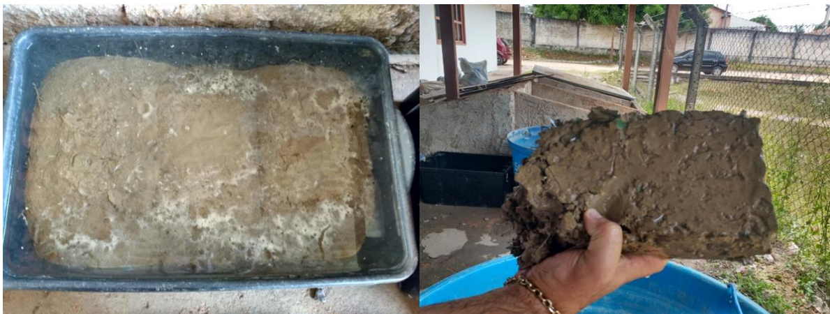
Figura 8 –a) Traços T.GP01, T.GP.02 e T.GP.03, respectivamente, b) Traço de adição de 5% de polímero pet, após a absorção total
