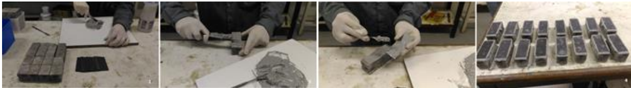
Figura 4 - Etapas de aplicação do reforço
