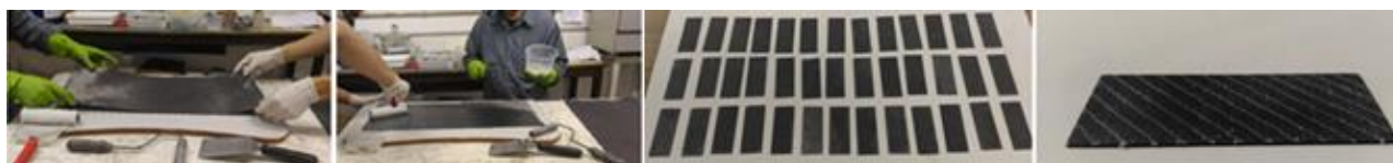
Figura 3 - Etapas de laminação do reforço e reforço cortado
