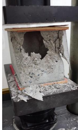
Figura 4 - Ruptura do bloco vazado de concreto
