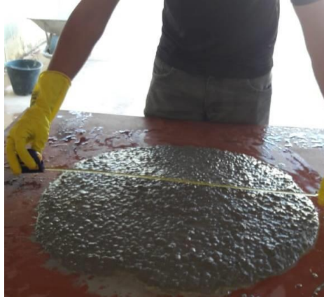
Figura 3 - Ensaio de espalhamento do concreto autoadensável
