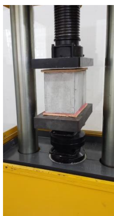
Figura 2 - Regularização das superfícies do bloco
