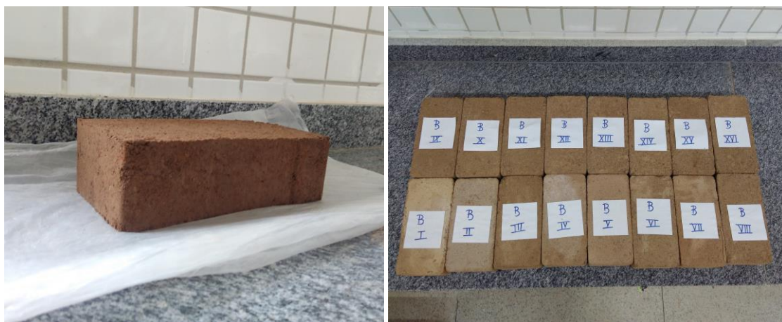
Figura 2. Presentación visual después de prensado, y disposición en bancada durante cura inicial.
