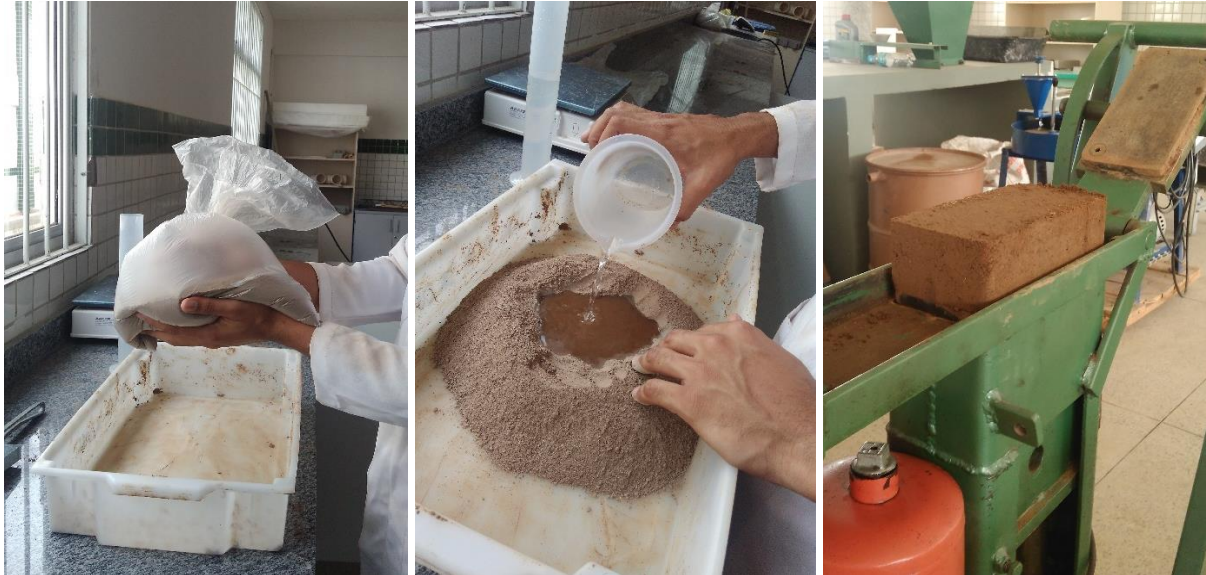
Figura 1. Homogeneización en seco, húmedo, y confección en prensa hidráulica.
