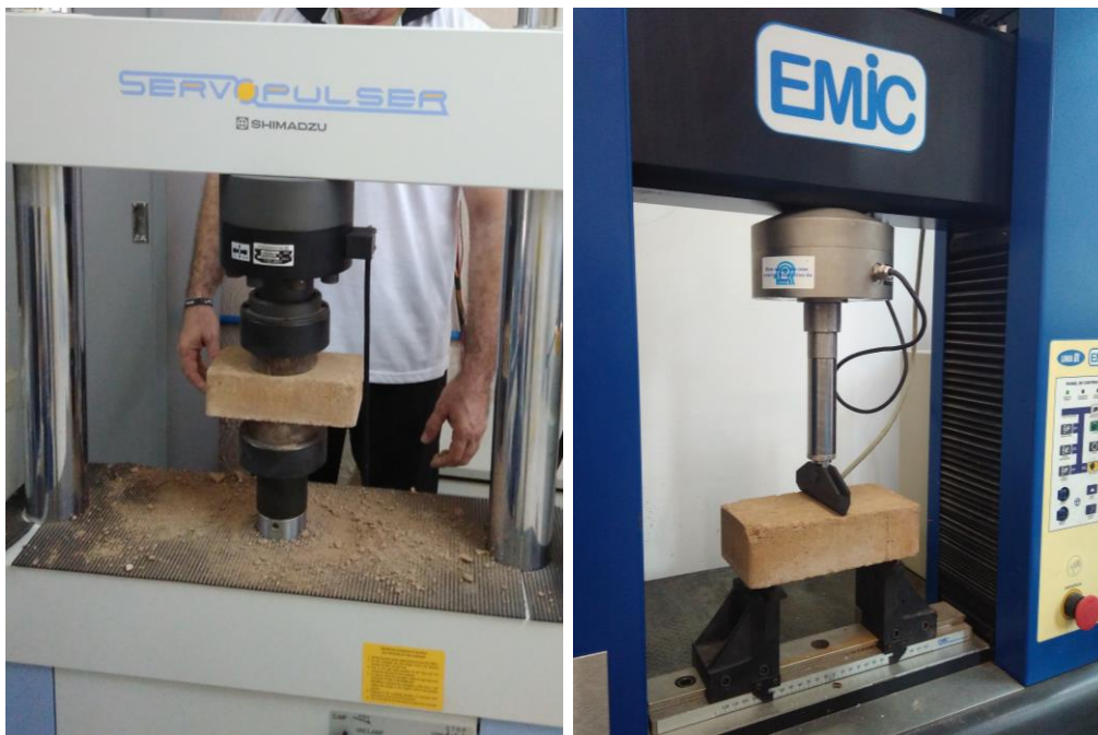
Figura 3. Realización de las pruebas de resistencia a la compresión (izquierda), y flexión (derecha).
