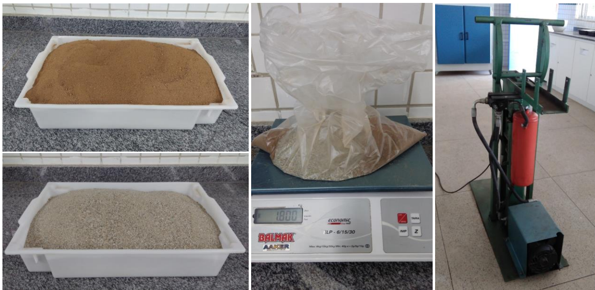
Figura 1. Solo, rejeito, pesagem para homogeneização a seco, e prensa hidráulica utilizada.
