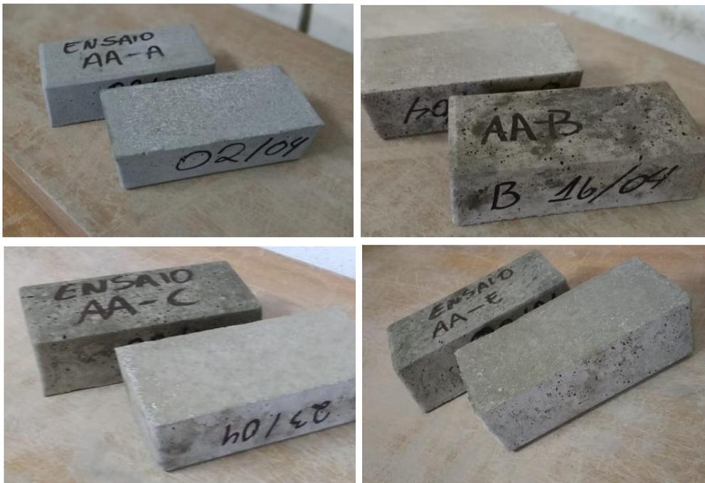
**Figura 5** – Amostra dos blocos dos traços A, B, C e E.
