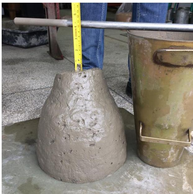
Figura 3: Verificação do abatimento dos traços de concreto
