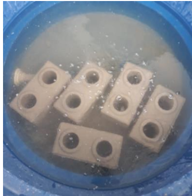
Figura 4 - Tijolos ecológicos no ensaio de absorção de água.
