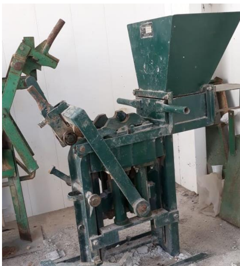
Figura 1 - Prensa manual de laboratório utilizada na confecção dos tijolos ecológicos.
