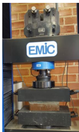
Figura 3 – Rompimento do bloco. Fonte: Os autores.
