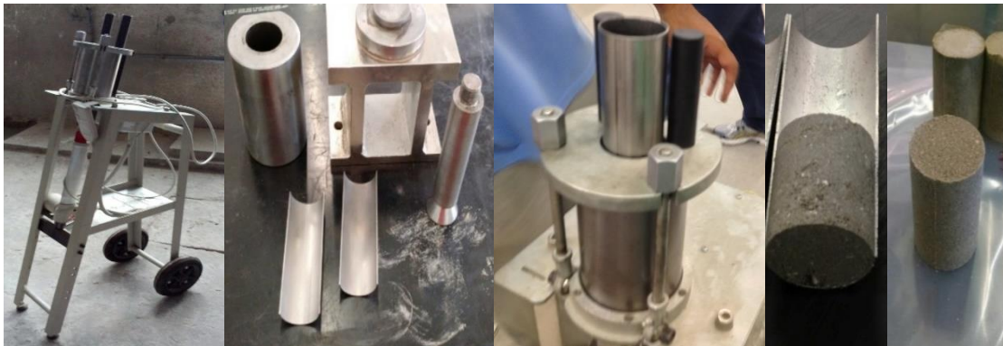
Figura 3 – Extrator automático dos corpos de prova; conjunto de moldagem (cilindro+ pistão + base) e moldes bi-partidos; corpos de prova após a compactação.
