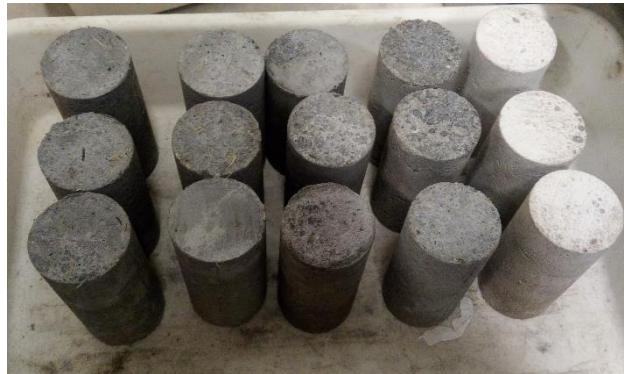
Figura 2 – Corpos de prova de argamassa com introdução de CBC, sendo o primeiro a esquerda com substituição de 30%, e na ordem os de 20%, 15%, 10% e o último de 0%.
