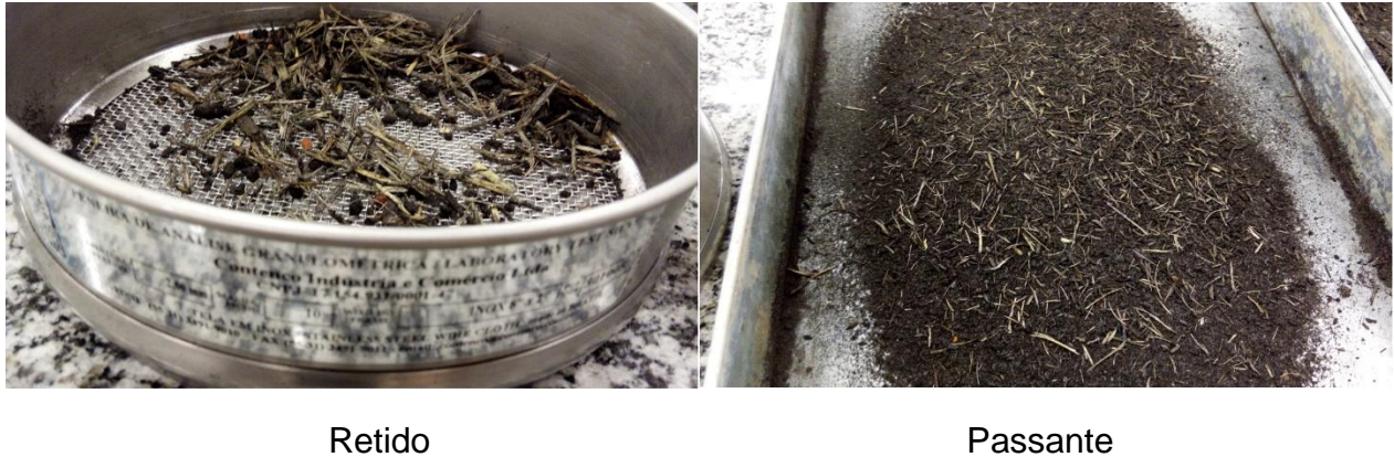
Figura 1 – Cinza do bagaço de cana de açúcar retido e passante na peneira malha #10
