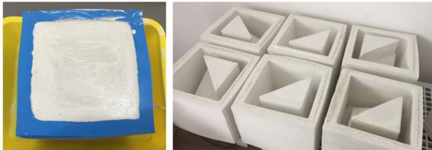
Figura 9 – Mistura de gesso hidratado, sílica e caulim no interior do contramolde de silicone para dar origem ao molde de gesso (esquerda) Moldes prontos secando (direita) (fonte do autor)
