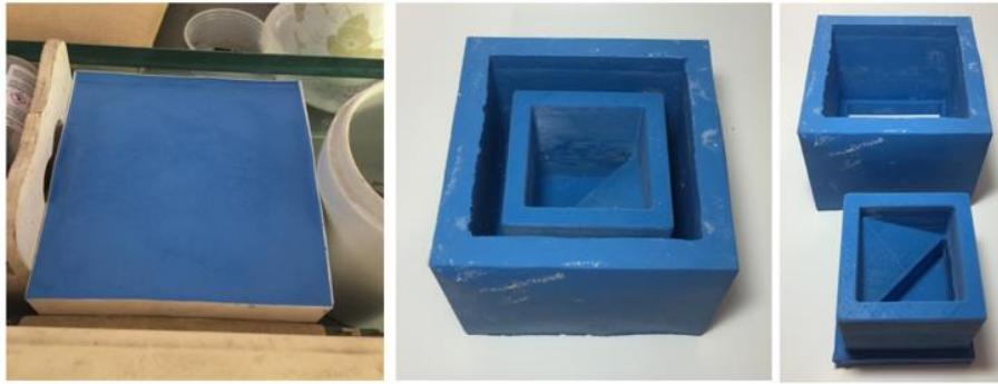
Figura 8 – Contramolde da peça em silicone sendo conformado (esquerda); Contramolde pronto (meio); Contramolde bipartido para facilitar o desmolde (direita) (fonte do autor).
