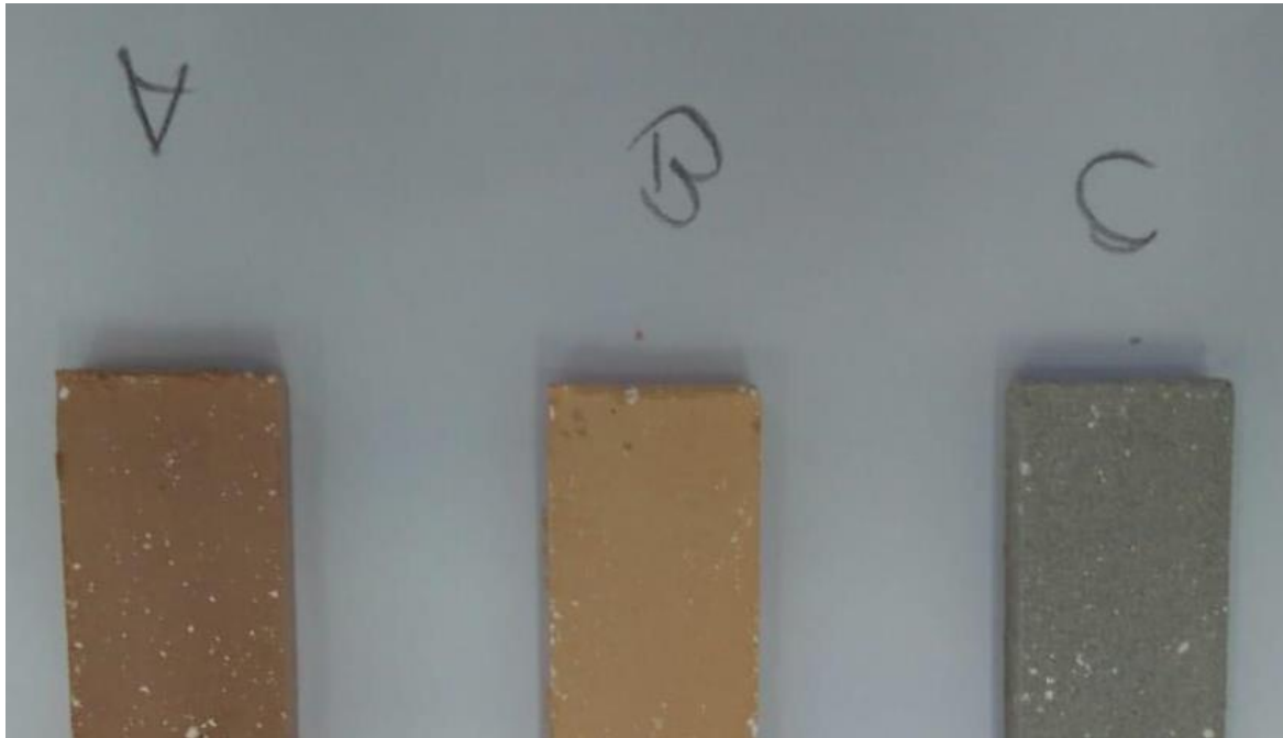
Figura 8. Pastilhas antes da sinterização. Composição: 70% argila colorida e 30% alumina.
