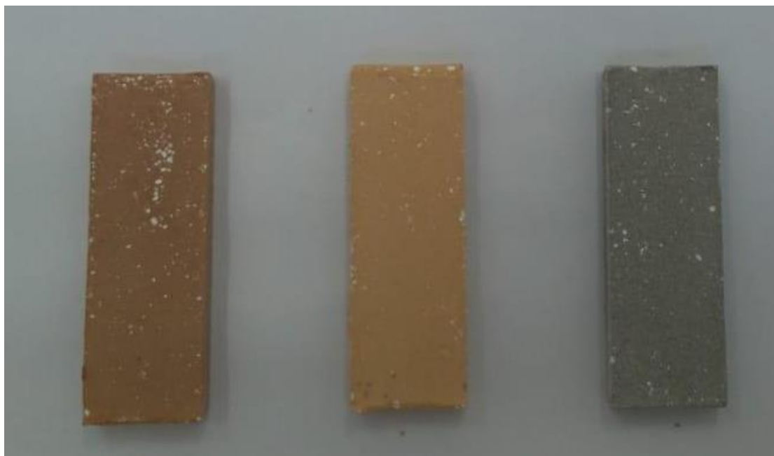
Figura 2. Pastilhas antes da sinterização. Composição: 70% argila colorida e 30% alumina.
