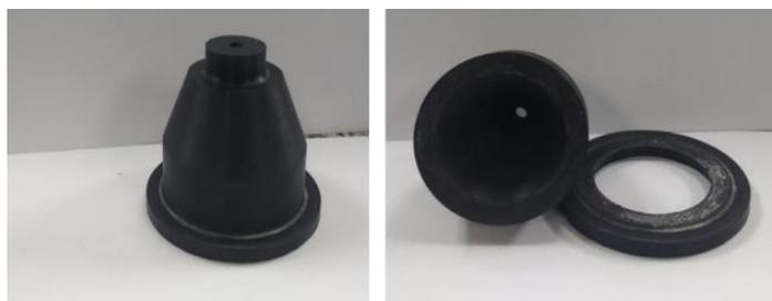
Figura 6 Bocal de extrusão rompido devido a intensa separação de fases ocorridas no método de extrusão por rosca contínua EMF-10.
