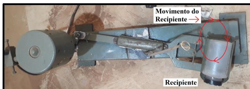
Figura 2: Agitador Dry-Beat e o circuito realizado pelo recipiente durante o ensaio.
