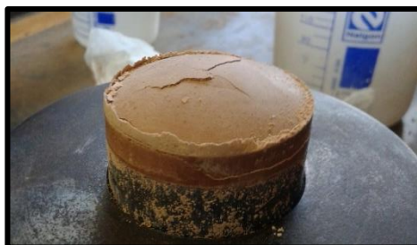
Figura 6: Fotografia da fragmentação do briquete aditivado com amido de milho na bauxita da granulometria A e com teor de umidade em 10%.
