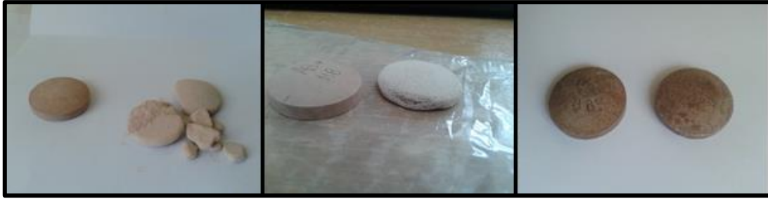
Figura 4: Comparativo entre o briquete antes (à esquerda) e o produto (à direita) do ensaio Dry-Beat. Na seqüência: 10(H 2 O)-(B); 3(AM)-10(H 2 O)-(B); e 5(LCS)-8(H 2 O)-(B).
