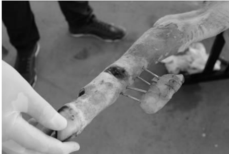
Fig. 7 – Membro inferior sendo preparado e posicionado para digitalização dos pontos pela técnica de Engenharia Reversa
