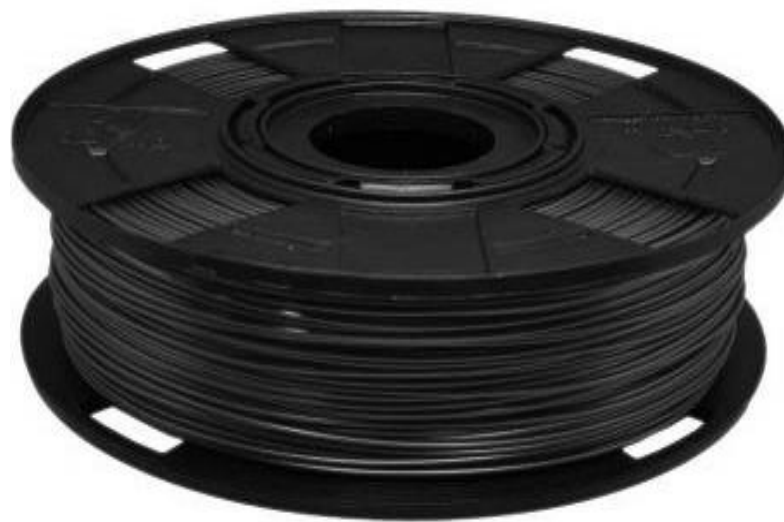
Fig. 6 – Rolo de Filamento PETG utilizado para fabricação da Órteses imobilizadora
