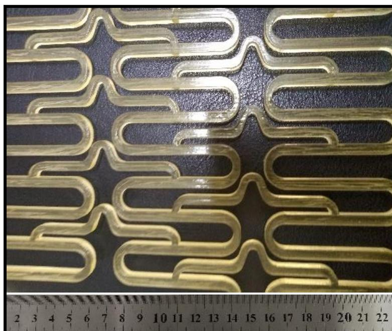
Figura 2: Protótipo do modelo 1 aberto do *stent* impresso em 3D no material FullCure 720.
