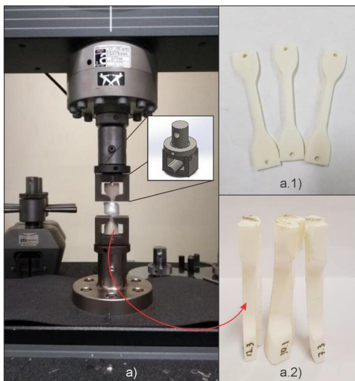
**Fig. 2:** a) Máquina de ensaio universal INSTRON 3382 durante o ensaio de tração com um dos corpos de provas digitalizados. Detalhe de garra especial (modelo CAD) para a realização do ensaio de tração. a.1) CP normalizados. a.2) CP digitalizados,
